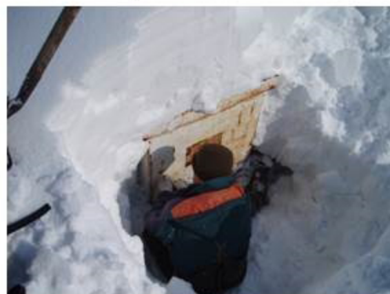
冬期は設備の上に積もった雪(平均で約2メートル)の除雪作業をしなければデータロガーに辿り着けない
