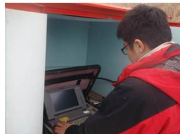
データロガーとPCを物理ケーブルで接続しデータ回収
